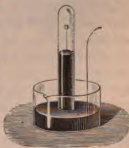
Fig. 89. — Analyse de l'air par le phosphore à froid.
